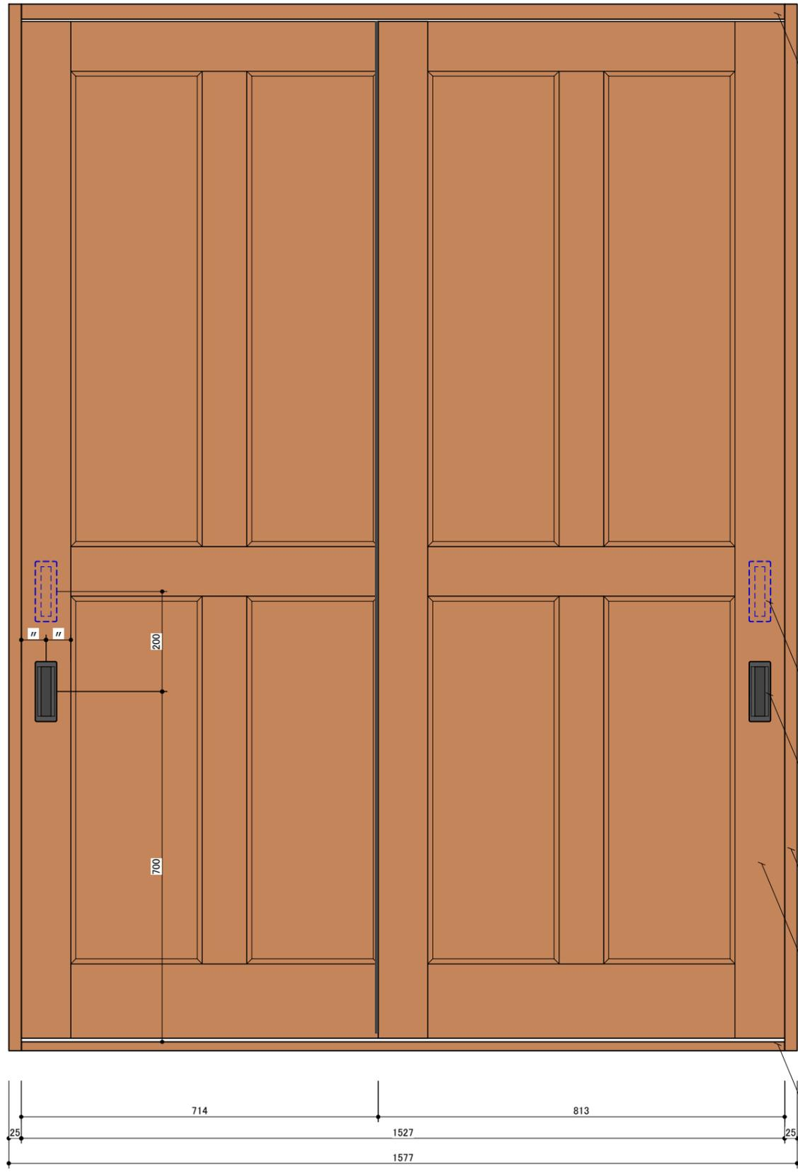
鴨居:米マツ 無垢材 T=30mm OS CL 仕上(マホガニー 艶有り) 吊り戸ハンガーレール埋め込み
