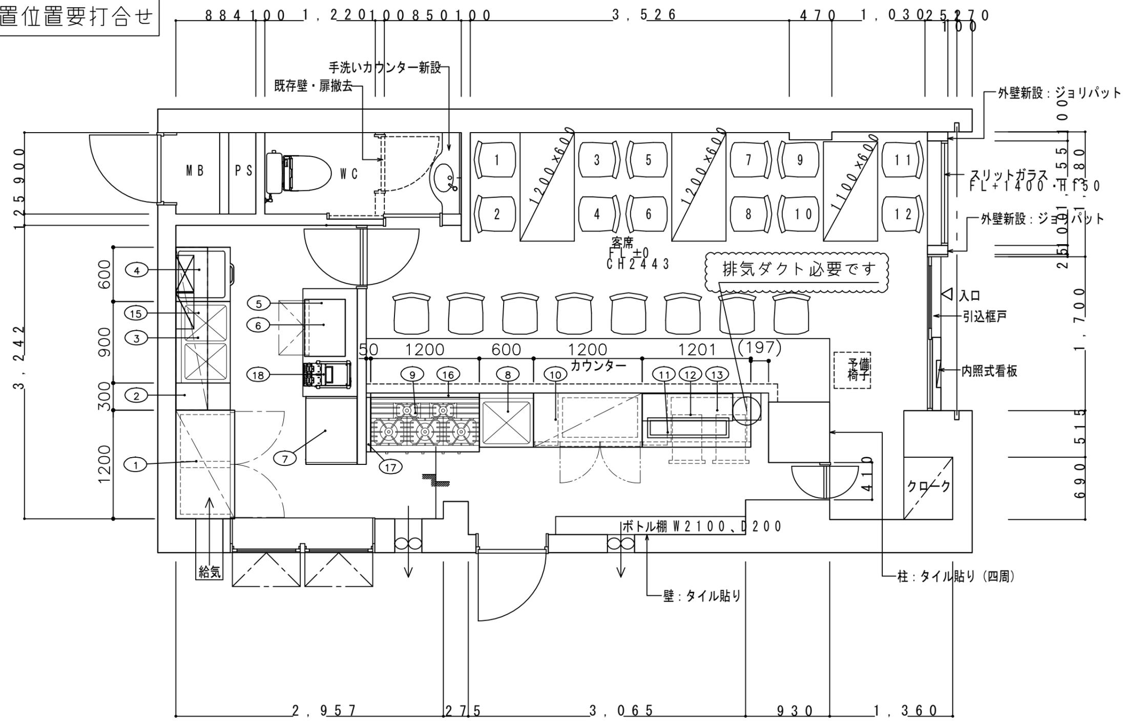
【注意】 壁は不燃構造で仕上げることを前提に設計しておりますが、加熱機器には火災防止の為、50mmの防熱板を設けています。防熱板は不燃構造と確認出来る場合のみ、取除く事が出来ます。厨房機器に対して有効な給排気量が確保されているものとします。
